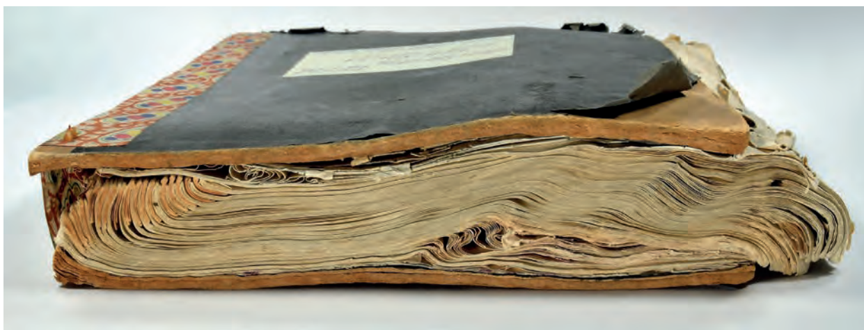
1. attēls. Muguras deformācija un bloka krokošanās, viļņošanās, foto Marika Vanaga
