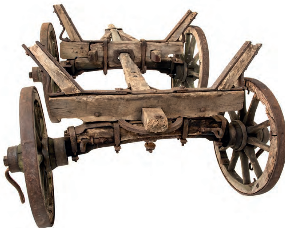
1. attēls. Vienjūga darba rati no priekšpuses pirms restaurācijas, foto Jānis Puķītis / Image 1. Front view of the wagon before restoration, photo Jānis Puķītis
