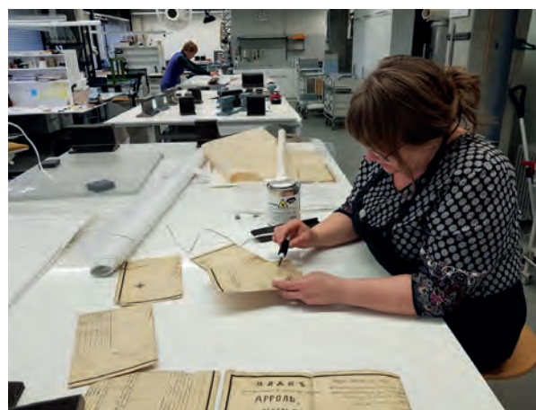
4. attēls. Kistka izmantošana ciklododekāna uzklāšanai ūdens jutīgu pigmentu fiksēšanai
